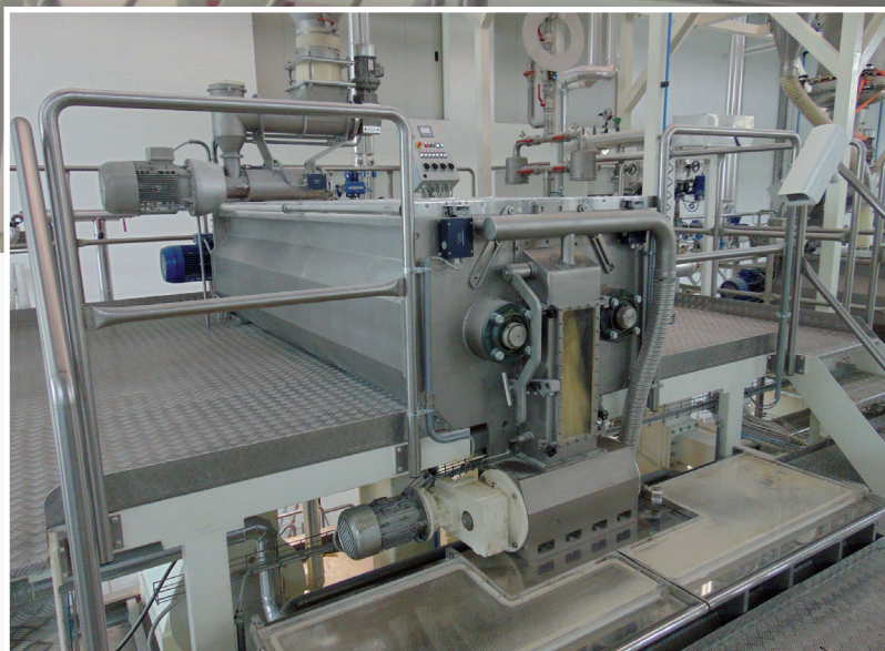
Vasche e capsulismo Mixing tanks and vacuum airlock Bacs de mélange et capsulisme Tinas amasadoras y capsulismo
