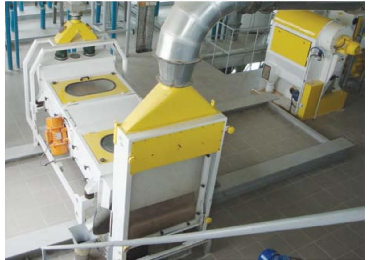
Vibroseparator á grain sont utilisés pour séparer les impuretés grossières et fines de céréales à des fins tant de pré-nettoyage pour les systèmes de stockage de céréales et pour le nettoyage principal dans les moulins à farine pour Nettoyage/purification efficace. Le principe de la séparation est basé sur la taille du noyau.
